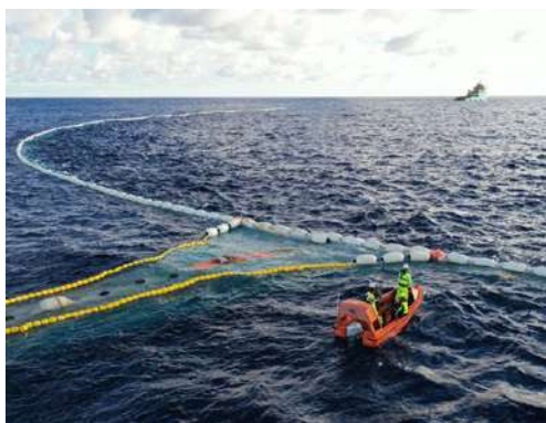
Fendere fra Dan-Hill-Plast A/S anvendes til opdrift af fangstnet i forbindelse med opsamling af plastaffald i havet. Kilde: The Ocean Cleanup.
