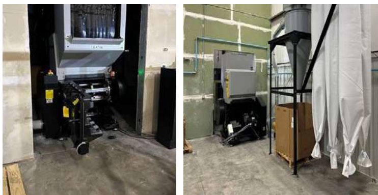
Plast kværn hos Gibo Inc. installeret i et nyetableret område i fabrikken.
