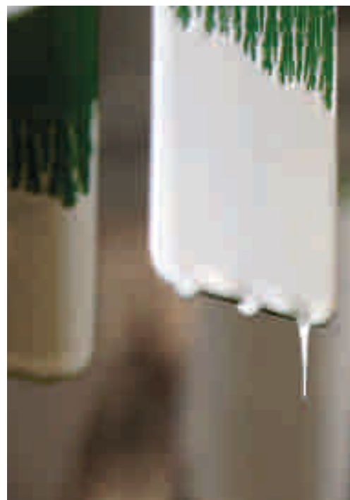
Malingen hæfter ikke på Accoats non-stick belægninger.
