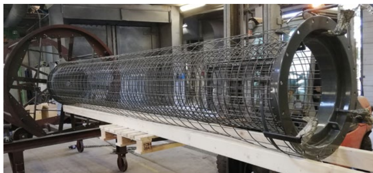
Procesudstyr med korrosionsbeskyttende Accotron® belægning til den kemiske industri.
