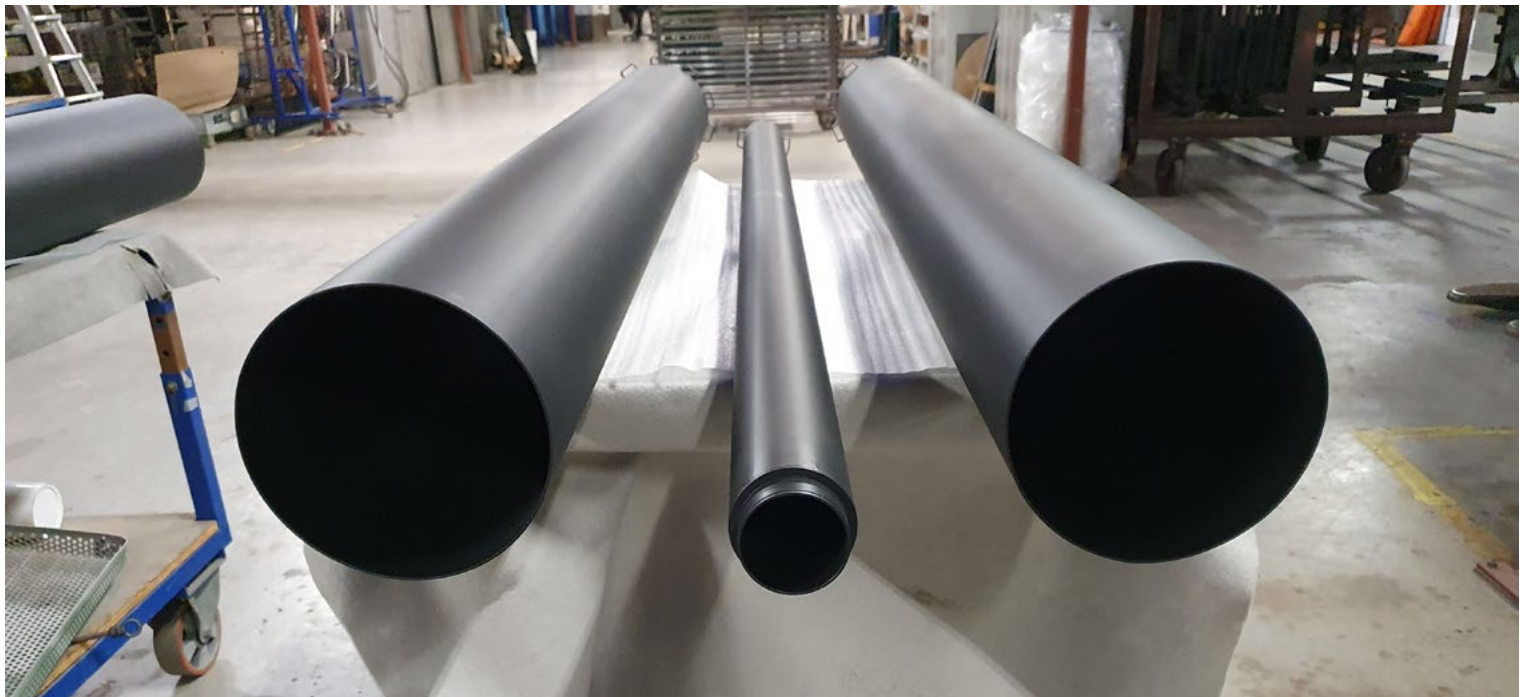
Rør belagt med Accolan P153 – en belægning til non-stick og lavfriktions applikationer
