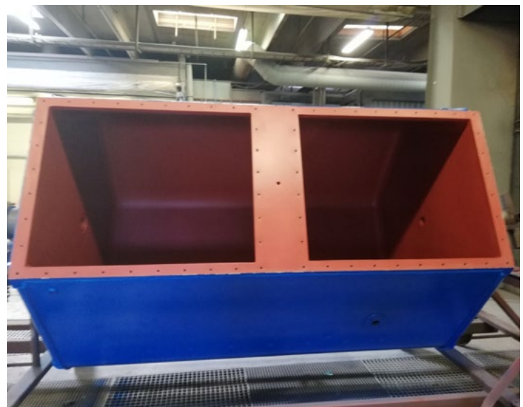
Kar belagt indvendigt med Accoshield RF for non-stick og korrosionsbeskyttelse
