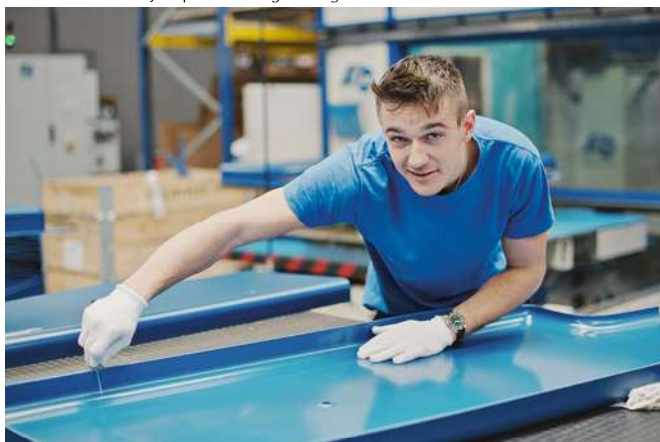
Andrezej Filipiak ved afgratning af vakuumformet emne.
