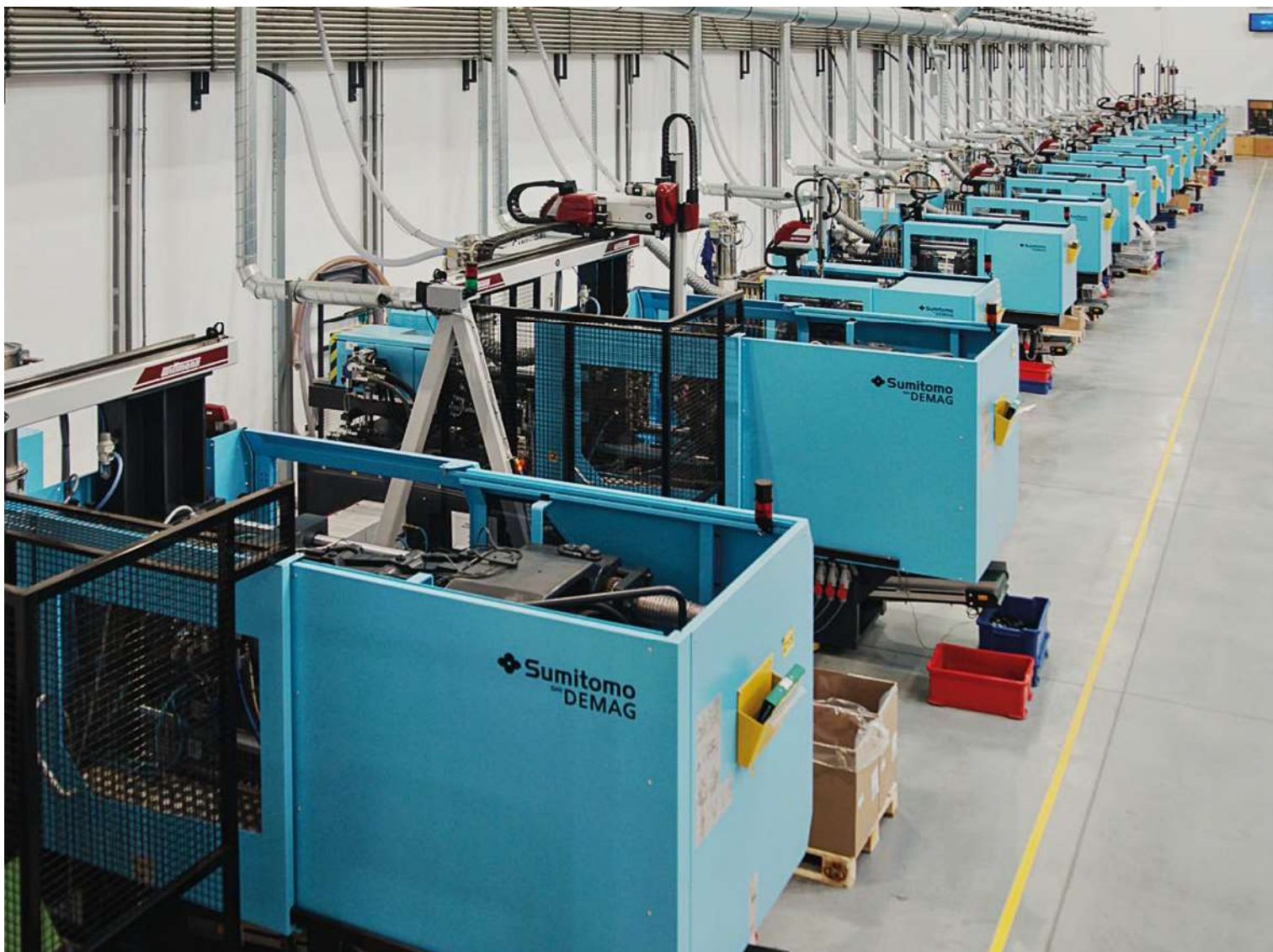
Sprøjtestøbmaskiner på SP Mouldings nye fabrik i Polen.
