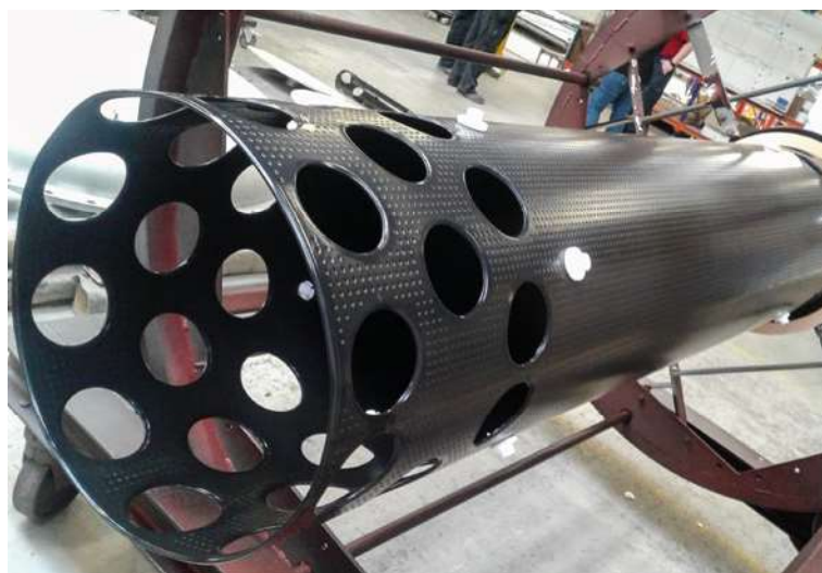
Procesudstyr med korrosionsbeskyttende Accoshield belægning.
