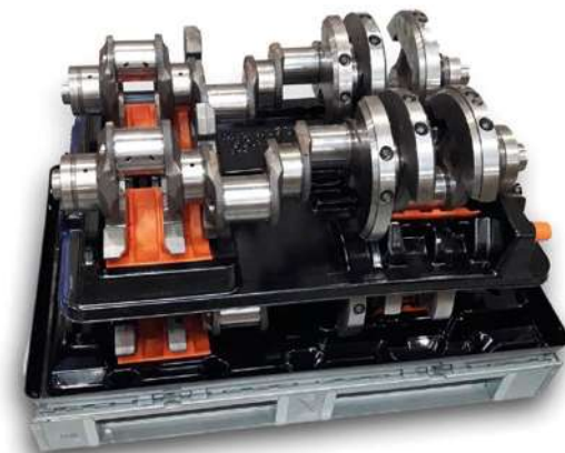
Nycopacs nyudviklede emballagesystem til transport af krumtapakster.
