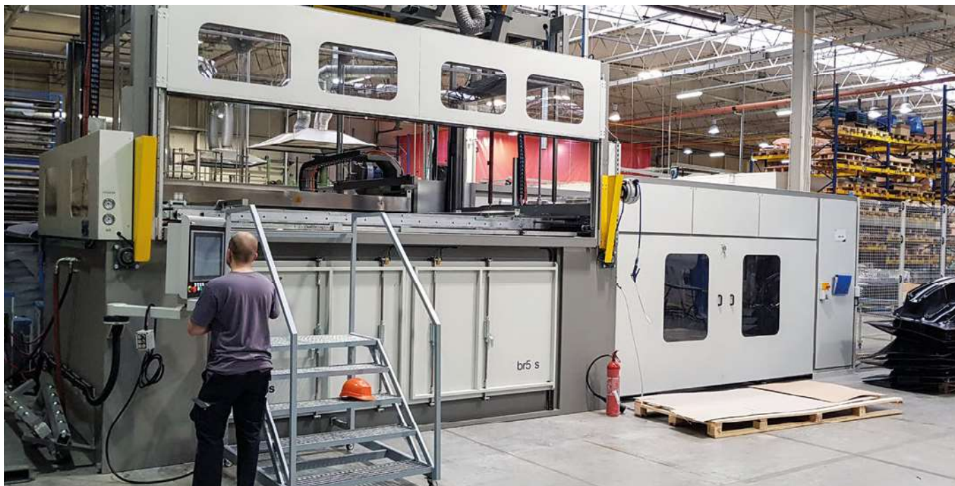
Gibo Plast har investeret i nye vakuumformningsmaskiner.
